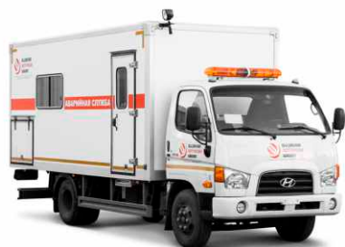
АВАРИЙНАЯ СЛУЖБА ДЛЯ ГОРОДСКИХ ЭЛЕКТРОСЕТЕЙ на шасси Hyundai HD78
