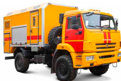
АВАРИЙНАЯ СЛУЖБА ДЛЯ ГОРОДСКИХ ЭЛЕКТРОСЕТЕЙ на шасси КАМАЗ 43501
