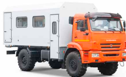
ВАХТОВЫЙ АВТОБУС НА 23 МЕСТА на шасси КАМАЗ 43502
